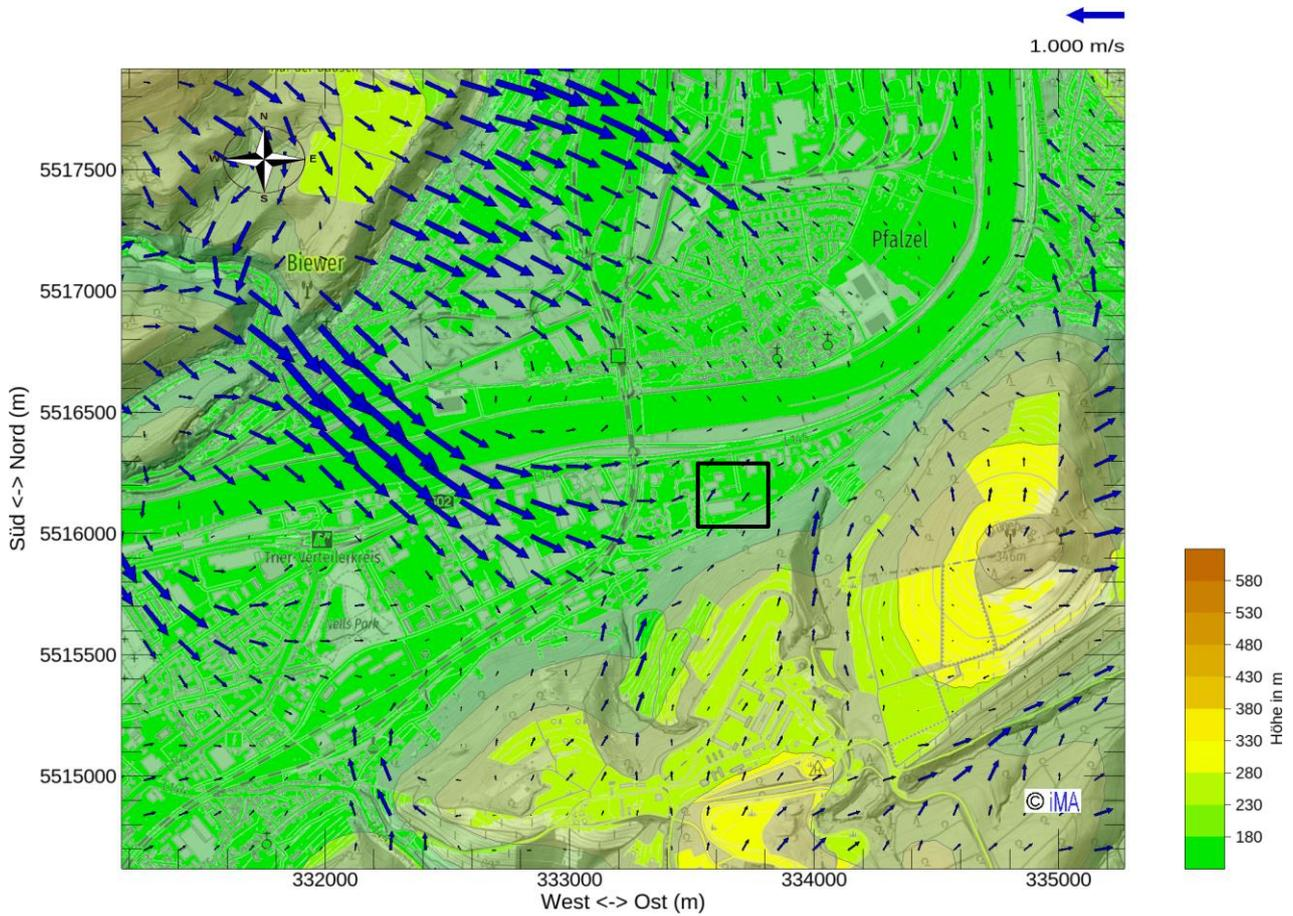
**Abbildung 7-1:** Ausschnitt eines METRAS-Windfelds in einer nächtlichen Kaltluftsituation. Die Strömungsrichtung ist durch die Pfeile markiert, die Geschwindigkeit ist an der Länge der Pfeile ablesbar. Der Bereich des Anlagenstandorts ist Schwarz markiert.
