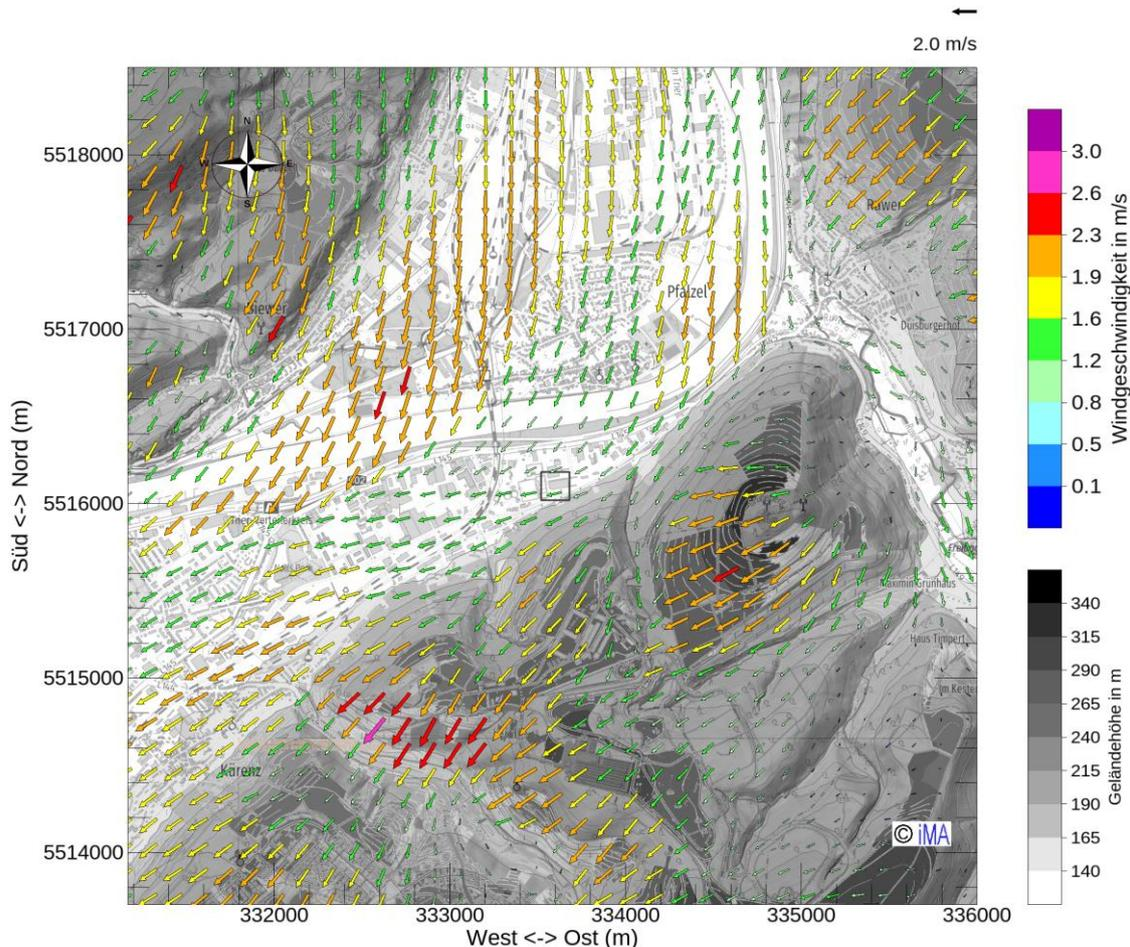
**Abbildung 5-1:** Ausschnitt des METRAS-Windfelds in ca. 10 m über Grund für die Ausbreitungsklasse I bei einer östlichen Anströmung. Dargestellt ist jeder zweite Windvektor. Der Bereich des Anlagenstandorts ist schwarz markiert (Kartengrundlage: onmaps.de © GeoBasis-DE/BKG2024).
