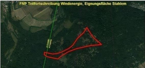
Die farbige Linie versteht sich als Punkt-zu-Punkt-Richtfunkverbindung der Telefónica Germany GmbH & Co. OHG. Das Plangebiet ist im Bild mit einer dicken roten Linie eingezeichnet.
