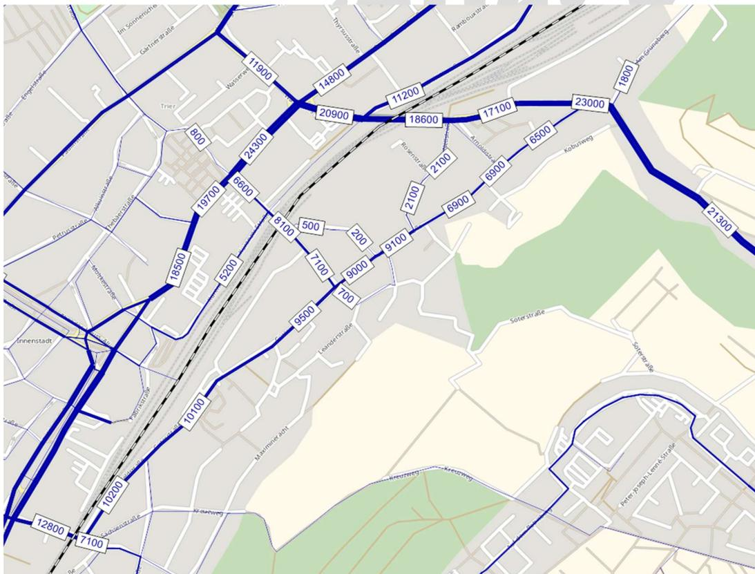
**Abbildung 8: Kfz-Verkehrsmengen im Prognose-Nullfall 2035 (Kfz / 24 h, DTVw)**
