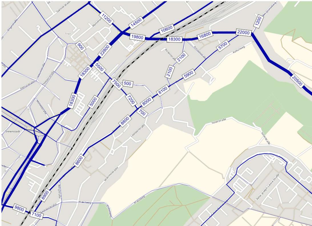
**Abbildung 2: Kfz-Verkehrsmengen im Ist-Zustand (DTVw, Kfz / 24 h)**
