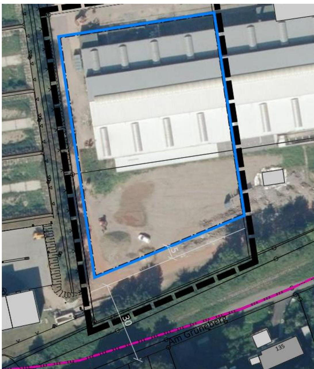
**Abbildung 5** Ausschnitt Planzeichnung mit eingetragenem Waldabstand 30,0 m und Abstand zur Baugrenze
