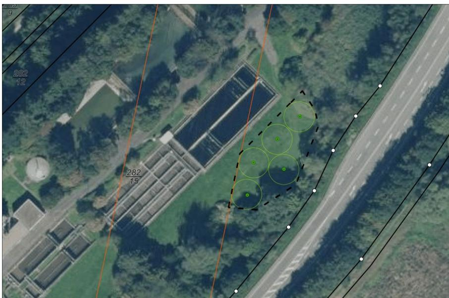
Abb. 11. Baumstandorte (grün, 12 m Durchmesser) im Teilbereich 2 außerhalb des Schutzstreifens der querenden Freileitung (rot).
